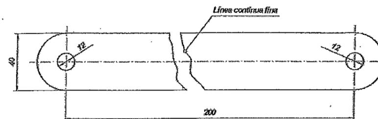
A) La figura representa una chapa de espesor 10 mm. Croquizar y acotar, en la vista dada, la sección abatida
